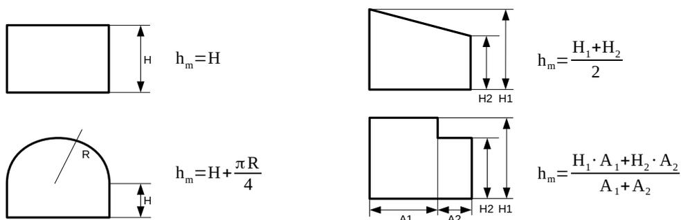
Illustrazione G.1-1: Esempi di determinazione dell'altezza media, in sezione
